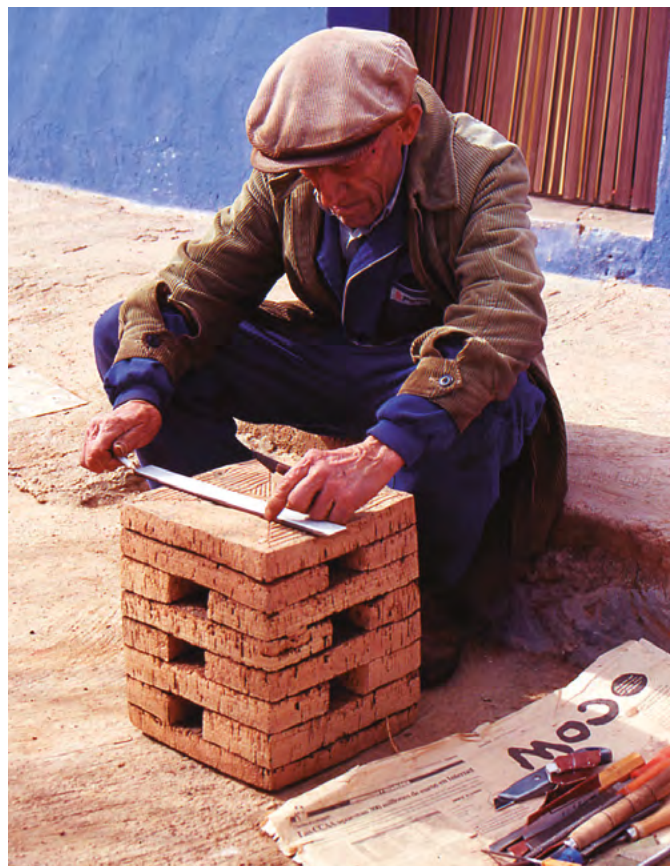
Fabricación artesanal de un taburete de corcho con clavos de jara (Cistus ladanifer). José Fajardo
